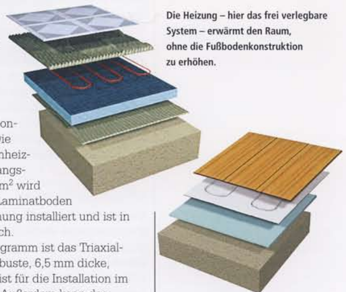
Ganz neu im Warmup-Programm ist das Heizsystem für Laminatböden mit glasfaserverstärkter Aluminiumheizfolie.
