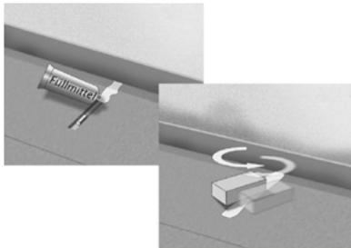
Dazu kann eine Aussparung mit einer Tiefe von 5 mm und einer Länge von 50 mm in den fertig verlegten **Warmup® Verbundplatten** angebracht werden. Der Fühlerdraht kann während der Verlegung der Bodenplatten zwischen den kurzen Quernähten zunächst zur Wand
