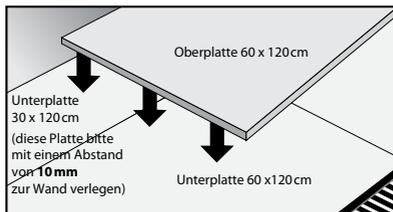
Bringen Sie die erste Reihe von Unterplatten wie folgt an: Die erste Plattenreihe der Länge nach in der Mitte durchschneiden. Die erste Unterplatte auf 3/4 der Länge kürzen. Anschließend die erste Reihe zum Lichteinfall hin platzieren (Schutzfolie nach oben), sodass überall an den Wänden und Anschlüssen mindestens 10 mm Dehnungsraum übrig bleibt. Das gilt auch für die übrigen Verlegearbeiten einschließlich des zu verlegenden Bodenbelags. Die zweite Reihe: Die erste ganze Platte auf
