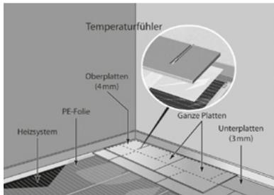
Der Sensor (Temperaturfühler) muss sorgfältig platziert werden. Vorzugsweise so nah wie möglich an der Oberfläche und weit genug aus der Wand heraus in dem Bereich, wo sich das Heizungssystem befindet, um so eine effiziente Steuerung des Systems zu erzielen.
