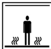
Unter diesem Boden befinden sich elektrische Leitungen und Heizflächen. Durchdringen Sie den Boden nicht mit Nägeln, Schrauben oder ähnlichem Befestigungsmaterial. Schränken Sie die Wärmeabgabe des beheizten Fußbodens nicht ein.
