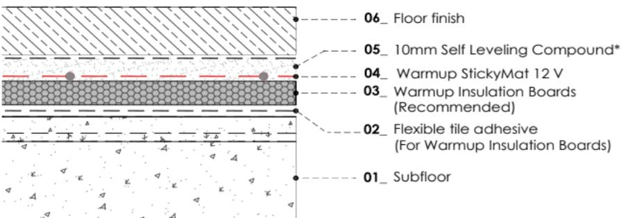
\* Mit dieser Methode kann eine glatte Bodenoberfläche erstellt werden, die für die meisten Bodenbeläge geeignet ist. Achten Sie in Nassbereichen darauf, dass die Mindeststärke der Ausgleichsmasse in den beheizten Bereichen 10 mm beträgt.
