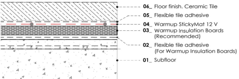
**HINWEIS:** Es ist möglich, das StickyMat 12 V-System direkt zu überfliesen. Es muss darauf geachtet werden, dass das Kabel nicht beschädigt oder geknickt wird.
