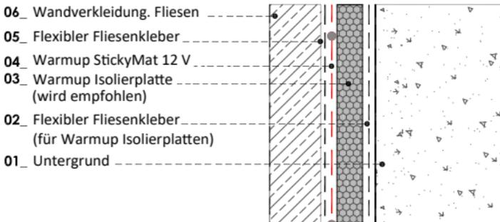
**HINWEIS:** Es ist möglich, das StickyMat 12 V-System direkt zu überfliesen. Es muss darauf geachtet werden, dass das Kabel nicht beschädigt oder geknickt wird.
