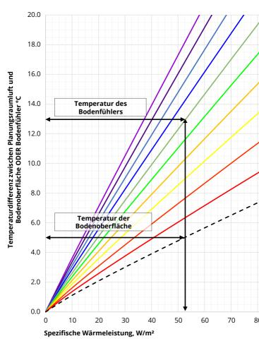
Anhand des obigen Diagramms kann die spezifische Heizleistung einer elektrischen Fußbodenheizung auf der Grundlage des Temperaturunterschieds zwischen der Raumlufttemperatur und der Fußbodenoberfläche oder der Temperatur des Fußbodensensors je nach Bodenbelag ermittelt werden.
