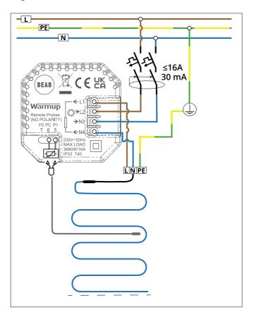
Warmup-thermostate sind für eine maximale Stromstärke von 16 Ampere (3680 W bei 230 V) ausgelegt. Zum Schalten von Lasten, die 16 Ampere überschreiten, muss ein Schütz verwendet werden.
