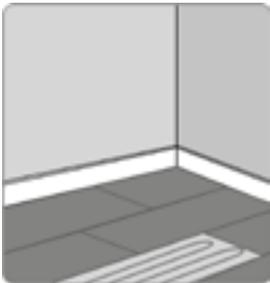
Stellen Sie sicher, dass das Heizsystem während der Installation nicht beschädigt wurde und vor der Verlegung des Bodenbelags vollkommen funktionsfähig ist. Details finden Sie auf Seite 9.
